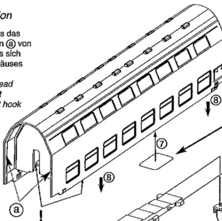
Silberfolie in die Innenseite des Gehäuses mittig an das Dach kleben (Lampenausschnitt im Leuchtstab)!
