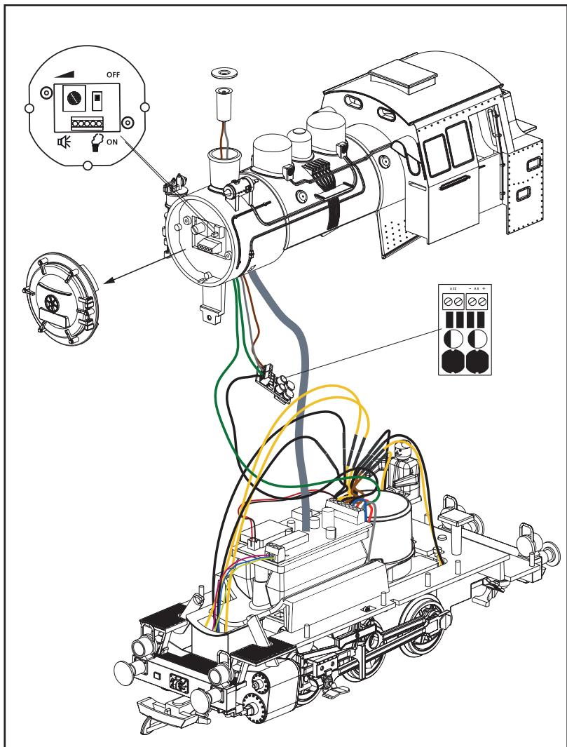
Die Lok ist bereits mit einem zuschaltbaren Dampfentwickler ausgestattet. Der Schalter befindet sich in der Rauchkammer. Nehmen Sie die Rauchkammertür ab. Schalten Sie den Dampfentwickler an (Schalterstellung unten) oder aus (Schalterstellung oben).
