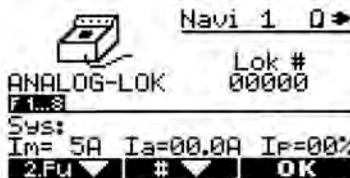
**HINWEIS:** Ein hochfrequentes Pfeifen analoger Lokomotiven auf dem Digitalgleis wird durch die besondere Form der Digitalspannung verursacht. Ein längerer Betrieb wird nicht empfohlen. Lichtwechsel ist generell nicht möglich. (Sehen sie hierzu in der Anleitung des Herstellers nach.)
