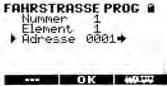
Lassen Sie die Adresse eines Elements frei und bestätigen dies mit **M3**, so wird das als Ende der Fahrstraße erkannt und der Navigator springt wieder in den Fahrbetrieb. Die Fahrstraße ist konfiguriert und kann geschaltet werden.
