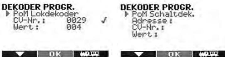
Das PoM-Programmierverfahren ist das einzige Verfahren, um eine Programmierung direkt im Betrieb auf dem Fahrgleis durchführen zu können. Dabei können bis auf CV 1 alle CV's im Dekoder per PoM programmiert werden. **Führen Sie die PoM-Programmierung bitte nur im Stand durch.**
