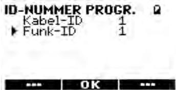
Sie können bis zu 8 PIKO Navigatoren mit dem PIKO Funkempfänger (EU #35012, US #35022) an Ihrer Anlage betreiben. Für jeden weiteren, per Funk betriebenen Navigator müssen Sie dessen Funk-ID manuell einstellen. „ID“ bedeutet Identifikation, beim PIKO Navigator ist es eine Nummer von 1 - 8. Nach dem Einschalten des Navigators wird oben im Display die entsprechende Navigator-ID angezeigt (z.B. „Navi 1“).
