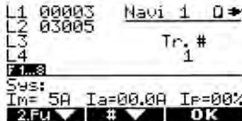
Wählen Sie in diesem Falle eine andere Traktion mit **M2** oder gehen Sie aus dem Traktionsmodus heraus mit **M3** und **M2**. Die Hauptfunktion des Navigators kann zwischen dem Steuern einer Lok oder Traktion umgeschaltet werden. Das Menü zeigt an der ersten Stelle anschließend nicht mehr die Option **Loktraktion** sondern **Lok fahren**. Damit kehren Sie in den normalen Lokmodus zurück.
