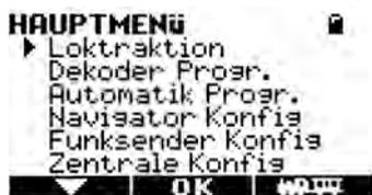
Das Prinzip der Menüs ist überall gleich. **M1** ist Navigieren, **M2** ist Bestätigen und **M3** ist Zurückkehren in den Fahrbetrieb.
