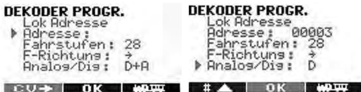
Hier wird die Lokadresse der Lok ausgelesen und programmiert. Die Adresse ist wählbar von 1-10239. Der Navigator berechnet automatisch die passenden Programmierwerte für CV 1, 17 und 18 + 29. Zusätzlich können Sie noch angeben ob der Decoder mit 14 oder 28 Fahrstufen betrieben werden soll, die Fahrtrichtung festlegen und den Analogbetrieb sperren.
