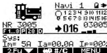
Wurde die Lokadresse korrekt gewählt, werden im Display die Daten der Lok angezeigt. Dazu gehören: Lokadresse, Lokname (wenn vergeben), Licht, Funktionen 1 bis 8 und natürlich Fahrtrichtung und Fahrstufe.
