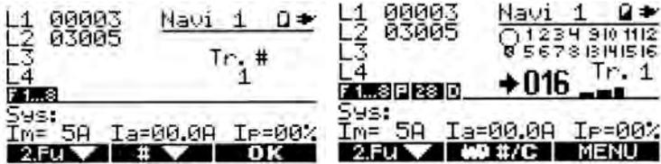
Über das Menü **M3** und **M2** wechseln Sie in den Traktionsmodus. Dabei werden im Traktionsmodus anstelle des Loksymboles die Adressen der bis zu 4 Traktionsloks angezeigt. Die Steuerung der Traktion ist mit der Loksteuerung vergleichbar. Ist in der ausgewählten Traktion eine unkonfigurierte Lokadresse vorhanden, so wird dies mit einem X hinter der Adresse angezeigt. Ebenso, wenn eine dieser Loks durch einen anderen Benutzer belegt ist.
