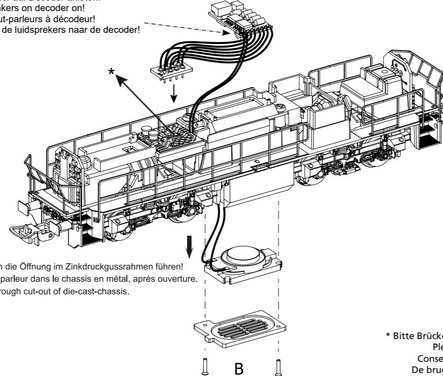
**!** Sicherstellen, dass dabei keinerlei elektrische Verbindungen zum Metallrahmen entstehen (Kurzschlussgefahr!).
