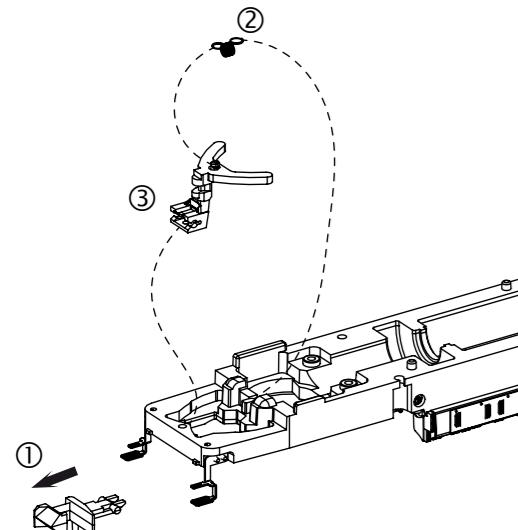
Drehgestellbauteile / Radsatzdemontage:
