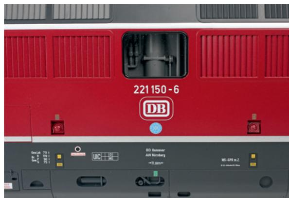
**Der beim Original beidseitig begehbare Maschinenraum ist bei Piko durch zwei seitenspezifische Spritzgussteile dargestellt. Die feine Bedruckung außen ist mehrfarbig, trennscharf und sauber aufgebracht – und das blaue Krauss-Maffei-Fabrikschild ist ein hübscher Klecks.**
