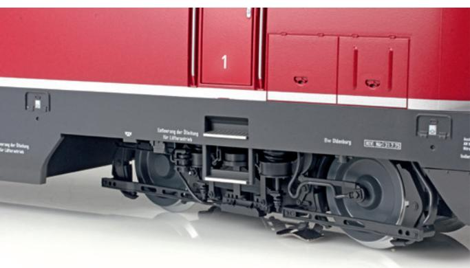
Anders als bei der BR 220, verfügen die Drehgestelle der BR 221 über vor den Rädern angebrachte Rahmenteile für die Stabilisierung der Bremsanlage. Leitungen, Federung und Indusimagnet sind detailliert nachgebildet, und nachts setzt eine Beleuchtung das Drehgestell in Szene. Die jeweils zwei angravierten Klappen am unteren Rand des Lokkastens weisen die rechte Lokseite aus, hier sind (beim Original) Bedienteile der Bremseinstellung und der Sifa zugänglich.
