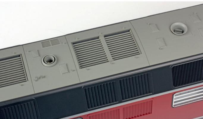
Die Dachgestaltung entspricht den Loks 221 101 bis 120, danach wurde eine Schalldämpferanlage mit zwei Abgasöffnungen je Motor eingebaut. Für die Handhabung der eingebauten Verdampfer ist diese Dachform jedoch vorteilhafter. Im Bild links die Abgasöffnung der Heizungsanlage mit einem statischen Verdampferrohrchen, rechts die Abgasöffnung von Motor 1.
