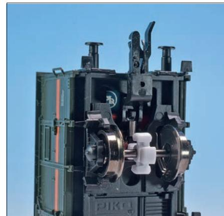
Für die Geschwindigkeits- und Streckenmessung werden die Radumdrehungen gezählt.
