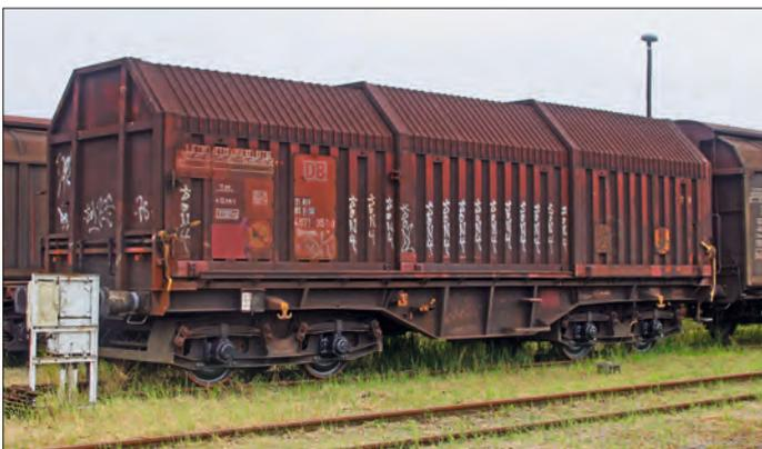
In Nordhausen wurde am 6. September 2009 dieser Shimmns-u mit Drehgestellen der Bauart 652 fotografiert. Im Vergleich erkennt man die treffende Umsetzung des Piko-Modells. An den Seiten der Hauben erkennt man kleine Bleche mit Löchern zum Kranen.
