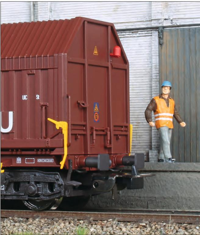
Typisch für die Epoche VI sind GPS-Antennen an einer der Stirnseiten der Wagen von DB Cargo, womit die Position des Wagens automatisch erfasst werden kann. Piko hat die Antennen Größenrichtig nachgebildet und an einem Wagen rot lackiert.
