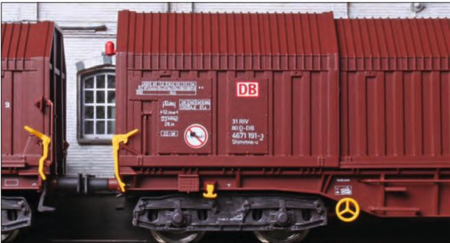
Links an den Seitenwänden sind die Blechimitate mit den bahndienstlichen Anschriften bedruckt. Die Seilhaken, die Räder der Handbremse und die Verriegelungen der Hauben sind gelbe Teile, die an die braun lackierten Wagen gesteckt sind.
