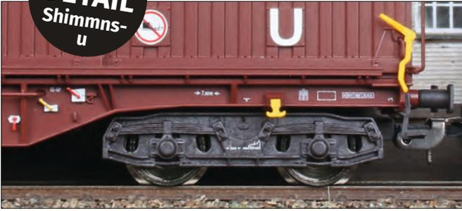
Das Piko-Modell des Shimmns-u – das „u“ steht für Gummimatten in den Mulden – läuft auf Drehgestellen der Bauart 652. Auf den Hohlprofil-Rahmenkonstruktionen der Stahlhauben hat Piko die Bleche mit den Beschriftungen korrekt nachempfunden.
