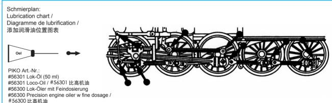
Ölen Sie bei häufigem Fahrbetrieb die Achslager mit einem Tropfen harz- und säurefreiem Nähmaschinennöl! Wir empfehlen, den Triebwagen ca. 25 min je Fahrtrichtung ohne Belastung einlaufen zu lassen, damit das Modell einen optimalen Rundlauf und eine gute Zugkraft erhält. Bitte beachten Sie, daß der einwandfreie Lauf des Modells nur auf sauberen Schienen gewährleistet ist.
