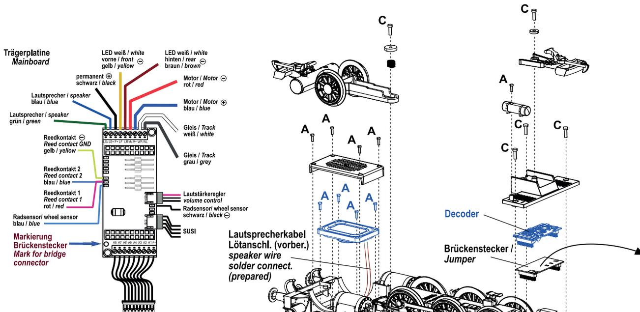
Entfernen Sie vorsichtig den Brückenstecker. Bitte nehmen Sie beide Hände, um ein Verkanten/Verbiegen der Kontakte zu vermeiden. Stecken Sie den Decoder auf die Trägerplatte. Durch seine Bauform lässt er sich nur in korrekter Position aufstecken. Achten Sie bitte dennoch darauf, dass die Kontakte nicht versetzt eingesteckt werden. Sollten Sie wieder auf Analog umrüsten, gehen Sie in umgekehrter Weise vor. Achten Sie beim Brückenstecker/Trägerplatte auf die Markierung (siehe Bilder).
