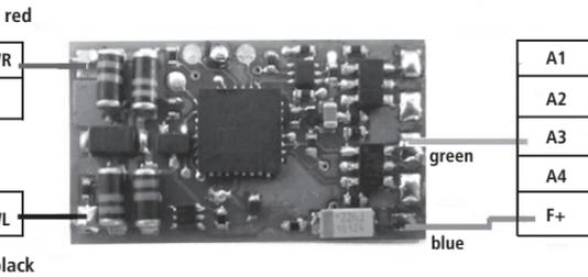
Über den eingesetzten Funktionsdecoder ist es auch möglich, die LEDs einzeln zu schalten. Dazu sind auf der LED-Beleuchtungsplatine Lötbrücken zu öffnen und andere zu schließen.
