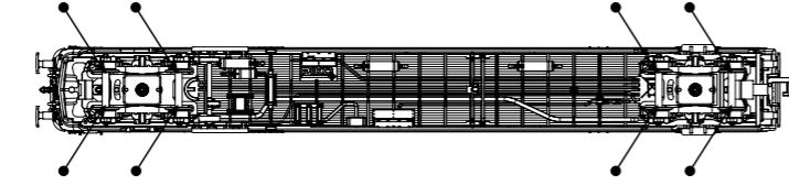
Ölen Sie bei häufigem Fahrbetrieb die Achslager mit einem Tropfen harz- und säurefreiem Nähmaschinenöl!
