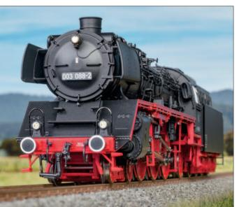
Die Frontansicht zeigt einige typische Elemente der DB-03: Rauchkammertür ohne Zentralverschluss, Reflexglaslampen, Witte-Windleitbleche und Stauschuten vor den Frontfenstern des Führerhauses.
