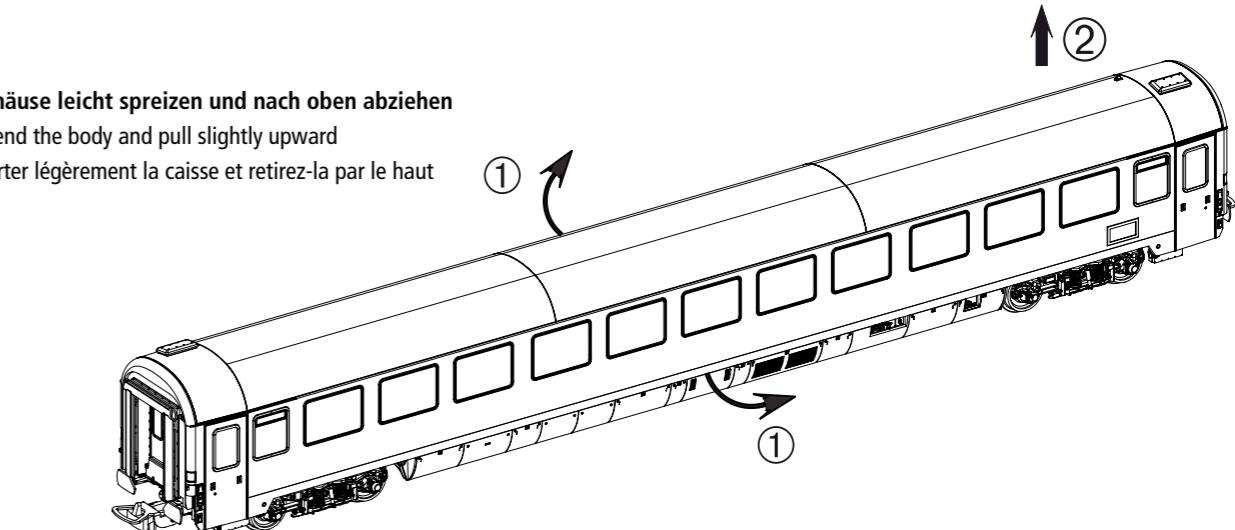
Gehäuse leicht spreizen und nach oben abziehen
