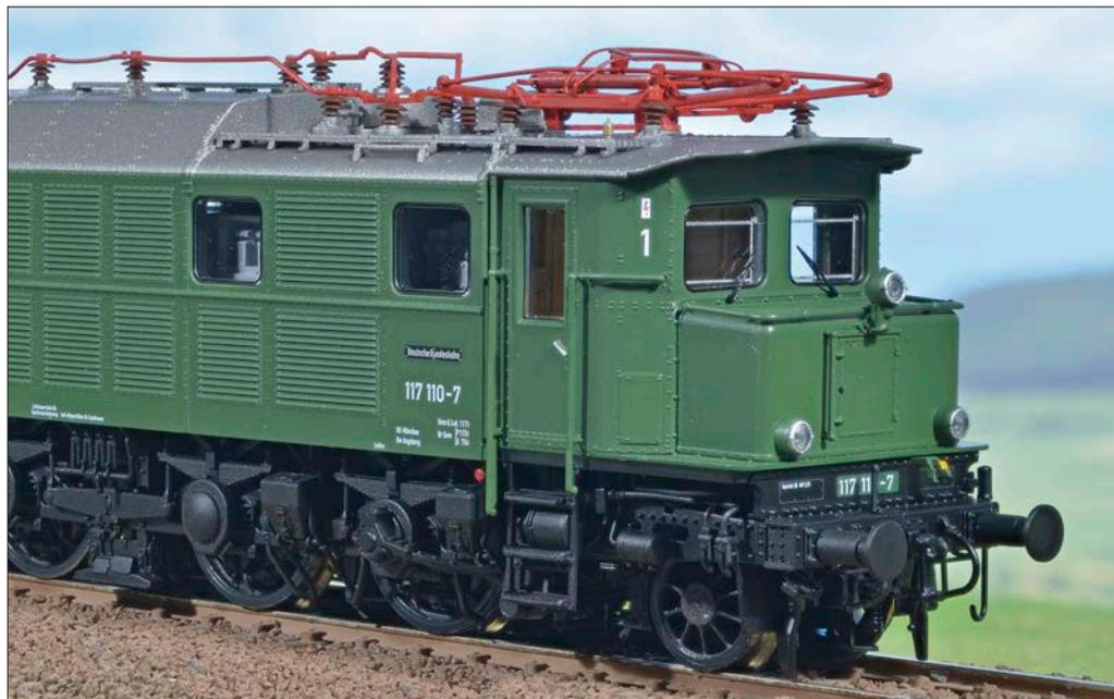
An den beiden Vorbauten ist nur die Seitenfläche vorn rechts völlig glatt. Alle anderen haben seitliche Wartungsklappen oder Lüftungslamellen. Ungewohnt muten die beiden großen, beim Original in Gummi gefassten Frontfenster an; sie sind jedoch an 117 110-7 authentisch. Das gilt auch für die dritte Spitzenlampe, die hier nicht mehr unter der Dachfläche angeordnet ist, sondern auf einem Lampenhalter an der Vorbaukante.
