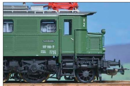
Nur noch die Eigentumsangabe ist ein Schild, alle anderen Anschriften sind in Weiß aufgedruckt. An den Rahmenenden ist im Bereich der Laufachsen vorn links die Leiter befestigt, hinten rechts sind der Ölabscheider der Druckluftanlage und Ausgleichbehälter zum Führerbremseventil montiert, während hinten links der Zwischenkühler der Druckluftanlage und vorn rechts der zweite Ausgleichbehälter sowie die beiden Absperrhähne der Hauptluftbehälter liegen.
