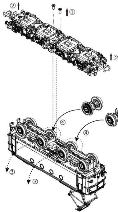
Dem Modell liegen zwei Austauschachsen mit haftreifenbestückten Rädern bei. Diese können bei Bedarf gegen die eingebauten Achsen ohne Haftreifen getauscht werden, um eine höhere Zugleistung zu erzeugen. Beim Einsatz mit Haftreifen kann es unter Umständen zu einer Beeinträchtigung der Stromaufnahme kommen.
