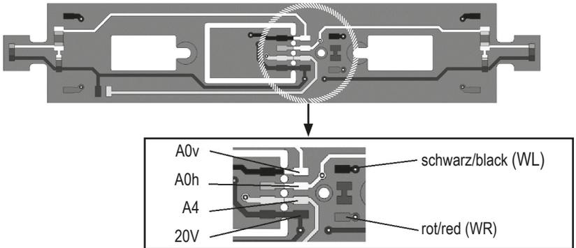
Funktionsdecoder-Anschluß am Beispiel des Beiwagen VT98 # 40681:
