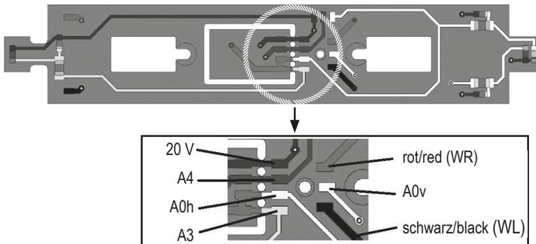
Funktionsdecoder-Anschluß am Beispiel des Beiwagens VT98 # 40680:
