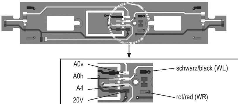
Funktionsdecoder-Anschluß am Beispiel des Beiwagens VT98 # 40681:
