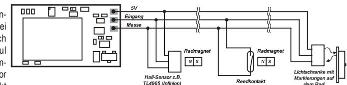
oder ein Hallsensor gemeinsam mit einem Magneten an einem Lokrad genutzt werden oder eine Lichtschranke mit einer entsprechenden Markierung auf einem Lokrad.
