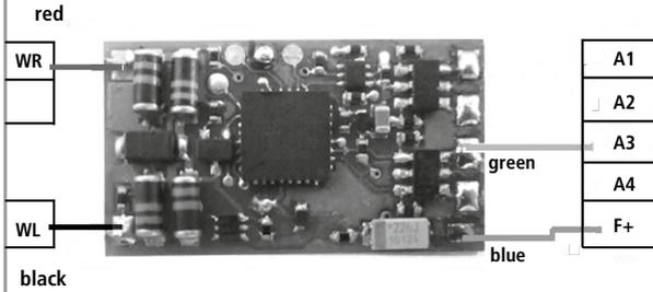
Über den eingesetzten Funktionsdecoder ist es auch möglich, die LEDs einzeln zu schalten. Dazu sind auf der LED-Beleuchtungsplatine Lötbrücken zu öffnen und andere zu schließen.
