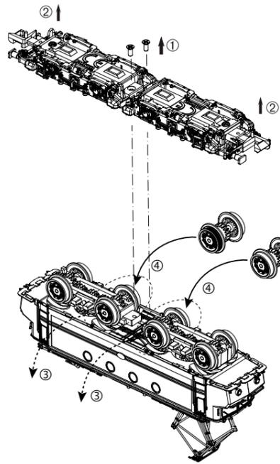
Dem Modell liegen zwei Austauschachsen mit haftreifenbestückten Rädern bei.
