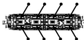
Ölen Sie bei häufigem Fahrbetrieb die Achslager mit einem Tropfen harz- und säurefreiem Nähmaschinenöl!
