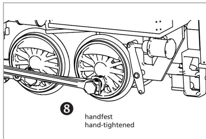
Die PIKO-Kurbelbolzen können in wenigen Schritten mit geeignetem Werkzeug montiert werden.
