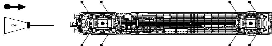
Ölen Sie bei häufigem Fahrbetrieb die Achslager mit einem Tropfen harz- und säurefreiem Nähmaschinenöl!
