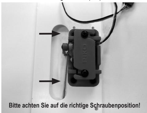
4. Stellstange in die Bohrung des Stromabnehmers stecken 5. Adapterplatte mit Gehäuse verschrauben
