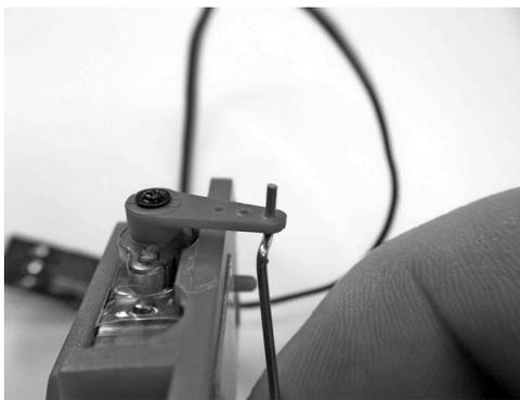
3. Servo mit Stellstange auf Adapterplatte verschrauben
