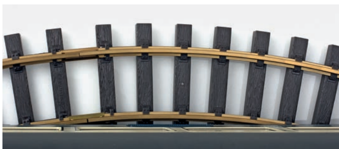
So steht die Mitte des langen Wagens im R1-Bogen „neben dem Gleis“...
