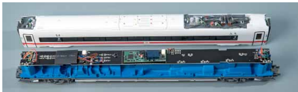
Der Modell-Antrieb sitzt in der Nachbildung des angetriebenen Servicewagens der zweiten Klasse. Die Platine trägt Decoder und Soundbaustein (links) sowie an der Unterseite die LED für die Innenbeleuchtung.
