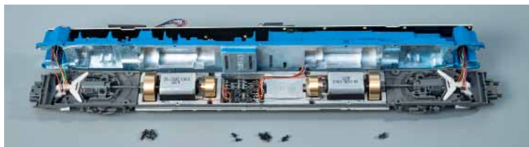
Nach dem Abnehmen des schweren blauen Gussteils mit der Inneneinrichtung fällt der Blick auf die beiden Motoren mit jeweils zwei Schwungmassen. Dazwischen liegt der Baustein zur Entstörung der Motoren.
