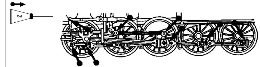
Ölen Sie bei häufigem Fahrbetrieb die Achslager mit einem Tropfen harz- und säurefreiem Nähmaschinenöl! Wir empfehlen, die Lok ca. 25 min je Fahrtrichtung ohne Belastung einlaufen zu lassen, damit das Modell einen optimalen Rundlauf und eine gute Zugkraft erhält. Bitte beachten Sie, daß der einwandfreie Lauf des Modells nur auf sauberen Schienen gewährleistet ist.
