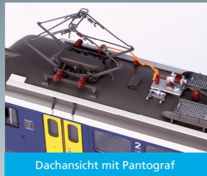
Dachansicht mit Pantograf
