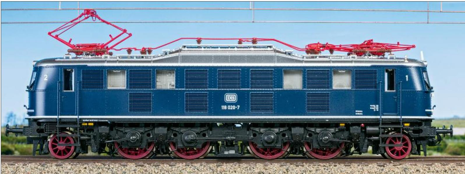
hören die entfernten Frontschürzen, die modifizierten unteren „Stielaugen“-Spitzenlampen, Dachstromabnehmer mit Doppelwippe sowie die blaue Lackierung mit unterem weißen Zierstreifen. Ein weiteres Merkmal sind die fehlenden Sandkästen in Lokmitte, die beim Einbau des Indusimagnetens weichen mussten.
