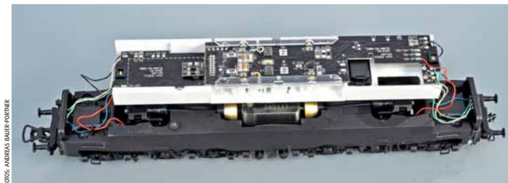
Durchdachte Konstruktion: Der Motor mit zwei Schwungmassen sitzt tief unter der Maschinenraumnachbildung aus Metall. Die obere Platine trägt auch die Maschinenraumbeleuchtung.
