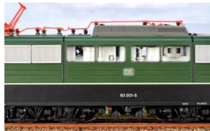
Alles richtig gemacht: Der Clou ist der mögliche Blick durch den Maschinenraum. Eines der Alleinstellungsmerkmale der 001 ist der breitere mittlere Steg zwischen den Maschinenraumfenstern.
