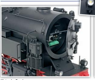
Hinter der Rauchkammertür befinden sich die Schalter zur Aktivierung der Triebwerksbeleuchtung und des Raucherzeugers im Schlot. Der Lautstärkeregler ist in der analogen Grundausführung ohne Funktion, da die Lok ohne Sound ausgeliefert wird. Für das Spitzensignal setzt Piko warmweiße LEDs ein, die keinen zur Fahrtrichtung passenden Lichtwechsel weiß/rot bieten.
