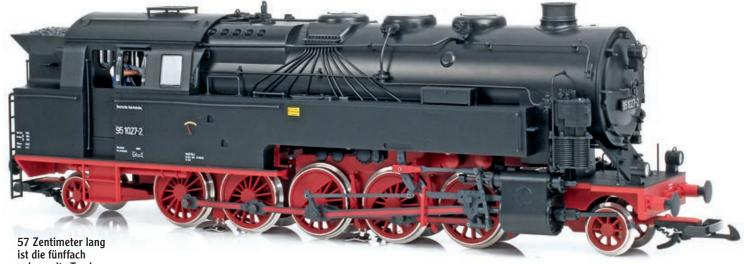
st die fünffach gekuppelte Tenderlok der Baureihe 95, sie bringt 3,7 Kilogramm auf die Waage und wird von zwei Bühler-Motoren angetrieben.
