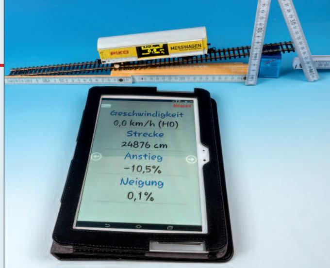
Mit diesem „Spezialaufbau“ wurde am Schreibtisch die Funktion der Steigungsmessung geprüft. Der gemessene Wert stimmt mit der errechneten Steigung gut überein.
