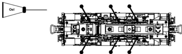
Si utilisation fréquente, huilez régulièrement avec une goutte d'huile fine pour machine à coudre. Nous vous conseillons un rodage complet de 25 min dans chaque sens pour un roulement optimal. Il est conseillé de nettoyer régulièrement vos rails pour un bon fonctionnement.
