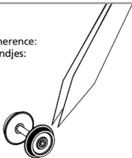
Si utilisation fréquente, huilez régulièrement avec une goutte d'huile fine pour machine à coudre. Nous vous conseillons un rodage complet de 25 min dans chaque sens pour un roulement optimal. Il est conseillé de nettoyer régulièrement vos rails pour un bon fonctionnement.
