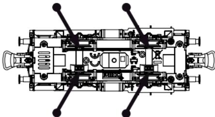
Si utilisation fréquente, huilez régulièrement avec une goutte d'huile fine pour machine à coudre. Nous vous conseillons un rodage complet de 25 min dans chaque sens pour un roulement optimal. Il est conseillé de nettoyer régulièrement vos rails pour un bon fonctionnement.
