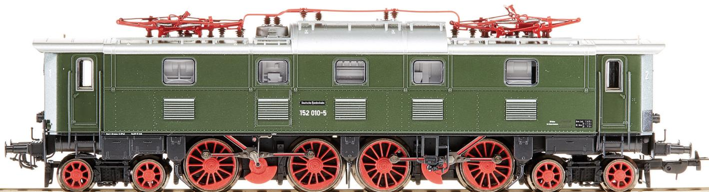
Die neukonstruierte Bayerin beeindruckt mit freiliegenden Speichenrädern an vier Drehgestellen, inklusive Blindwellen und Treibstangen.
