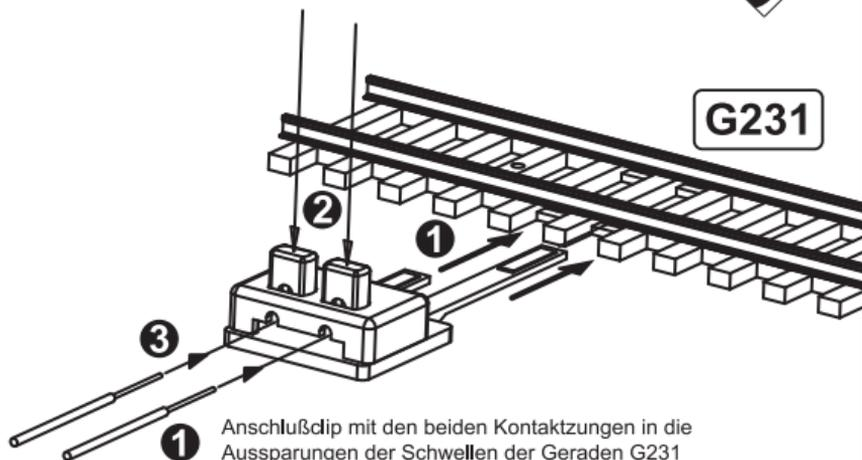
**1** Anschlußclip mit den beiden Kontaktzungen in die Aussparungen der Schwellen der Geraden G231 bis zum Anschlag einschieben.
