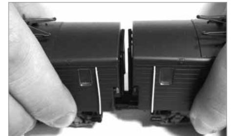
Gehäuse leicht spreizen und nach oben abziehen
