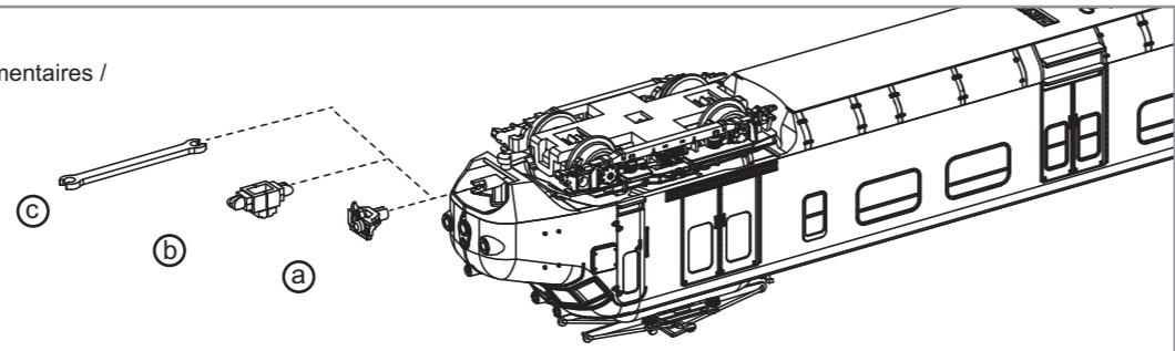
a) Triebzug einzeln / multiple unit / multiple unit individuellement / 单个动力车头挂钩
