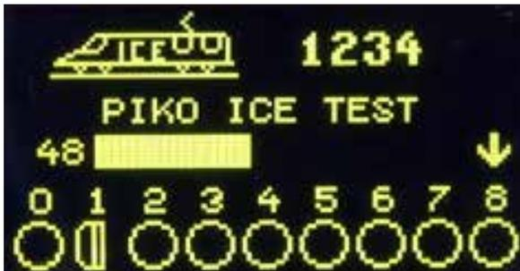
Die Licht- und bis zu 8 weitere Sonderfunktionen können über die Zifferntasten direkt geschaltet werden. Im DCC-Betrieb sind je nach Digitalzentrale bis zu 32.768 Sonderfunktionen pro Lokadresse erreichbar.
