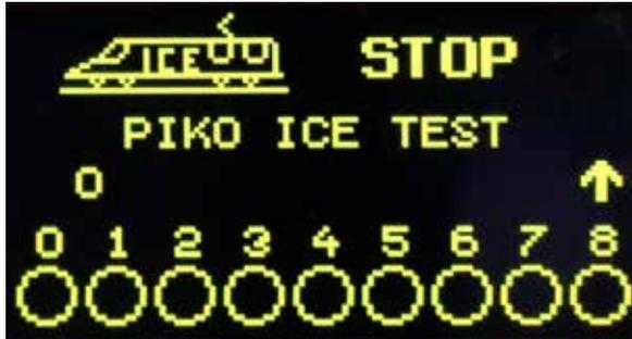
Ist die gewünschte Lok nicht in der Liste, so kann über den Zifferblock eine Lokadresse eingegeben werden. Hier kann mit der [stop/löschen]-Taste die zuletzt eingegebene Ziffer gelöscht und die Eingabe mit der [lok]- oder [↔] - Taste abgeschlossen werden.
