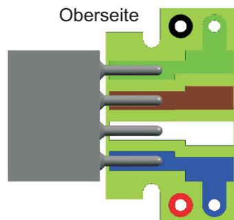
Das für den Anschluss einer Innenbeleuchtung vorgesehene grüne Kabel "X" ist im Auslieferungszustand so verdrahtet, dass die Innenbeleuchtung elektrisch gesehen parallel zur Frontbeleuchtung liegt.
