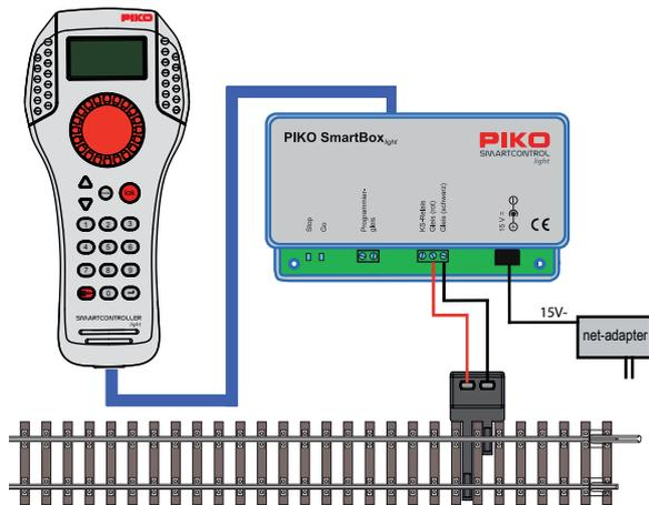
Verbind de **PIKO SmartControl<sub>light</sub>** componenten met elkaar volgens het nevenstaand schema. Vervolgens schakelt u de bedrijfsspanning in door de net-adaptor in het stopcontact te steken. De groene controle-LED licht op en in de display van de **PIKO SmartController<sub>light</sub>** verschijnt de loc-modus.
