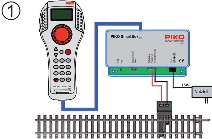
Schließen Sie **PIKO SmartControl<sub>light</sub>** Komponenten entsprechend der Aufbauskizze an und schalten sie die Betriebsspannung ein, indem Sie das Steckernetzteil in eine Steckdose stecken. Die grüne Kontroll-LED leuchtet und im **PIKO SmartController<sub>light</sub>** erscheint der Lokmodus.
