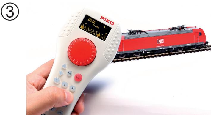
Die Licht- und bis zu 8 weitere Sonderfunktionen können über die Zifferntasten direkt geschaltet werden. Über die Tasten up / down ([▲] / [▼]) können weitere Funktionen aufgerufen und über die Zifferntasten geschaltet werden.
