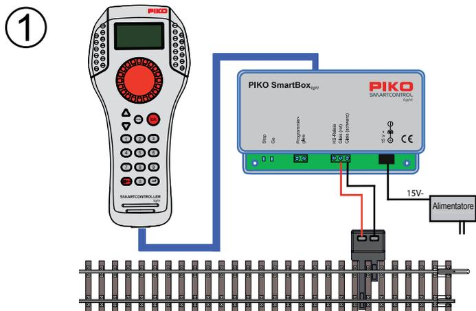
Collegare i componenti di **PIKO SmartControl<sub>light</sub>** come da schema di allestimento ed inserire la tensione di alimentazione, innestando il connettore dell'alimentatore in una presa elettrica. Il LED di controllo verde si accenderà e nel **PIKO SmartControl<sub>light</sub>** comparirà la modalità Locomotiva.
