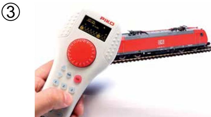
La funzione Luci e sino ad 8 ulteriori funzioni speciali si potranno gestire mediante i tasti numerici. Premendo i tasti Su / Giù ([▲] / [▼]), si potranno richiamare ulteriori funzioni e, anche in questo caso, le si potrà gestire mediante i tasti numerici.
