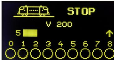
Alle Informationen über die Lok, Geschwindigkeit und Fahrtrichtung, Zustand der Loksonderfunktionen oder der gerade ausgewählte Betriebsmodus, z.B. im Magnetartikelmodus die Anzeige der Weichenlage, sind so leicht erkennbar.
