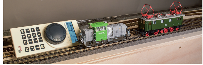
Ein Versuch, den man nicht unbedingt nachmachen muss: Die G6 ist eine analoge Lok und wird hier über die Adresse 0 der Lenz-Zentrale gesteuert. Die E 32 wird ganz normal per DCC kontrolliert.
