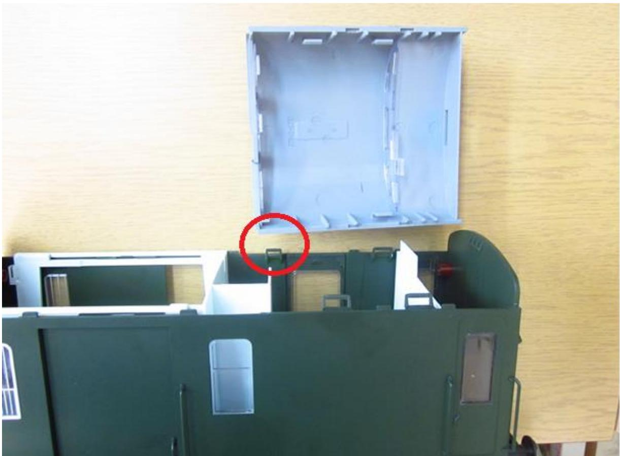
Verrastung lösen und das Kanzeldach mit etwas Kraft nach oben abziehen um die restlichen Verrastungen zu lösen.
