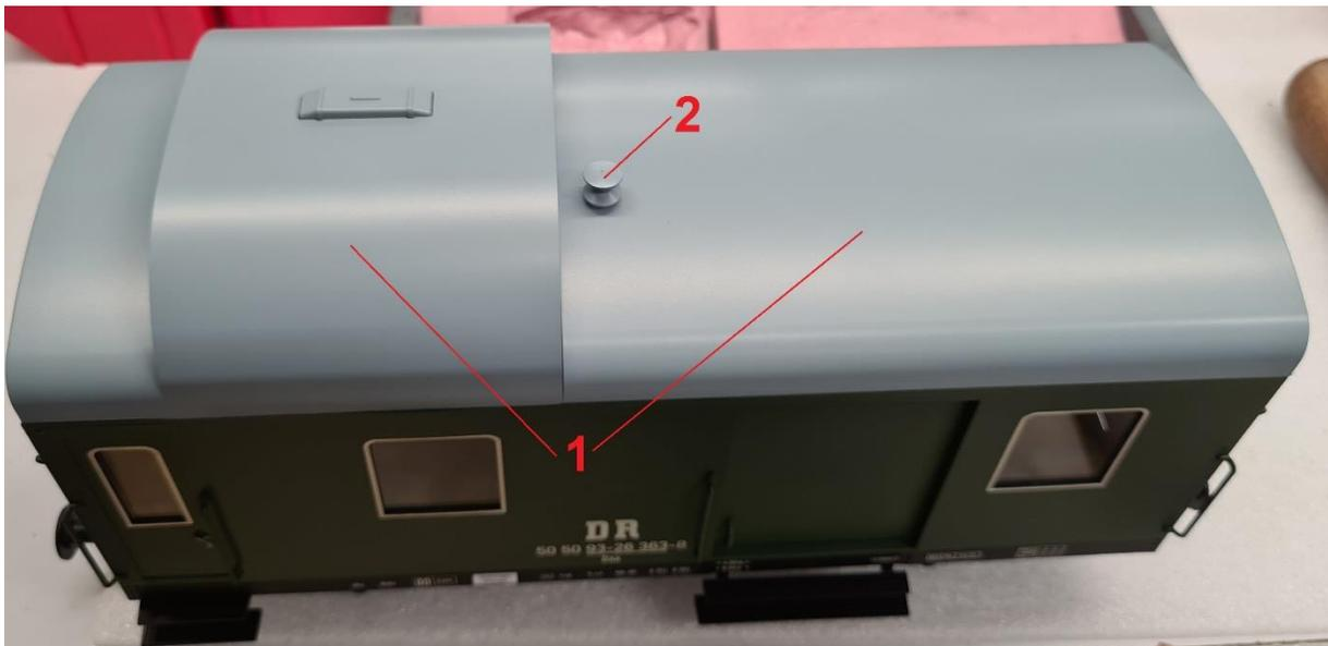
1) Zuerst wird das Dach mit der vormontierten Dachkanzel verbunden und gleichmäßig auf den Wagenkasten montiert.
