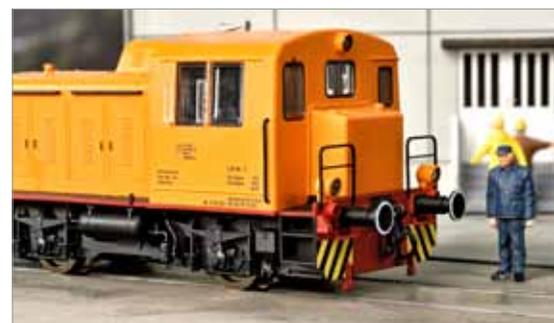
Die Scheibenwischer sind angespritzt, die Geländer an den Enden bestehen aus Ätzteilen.
