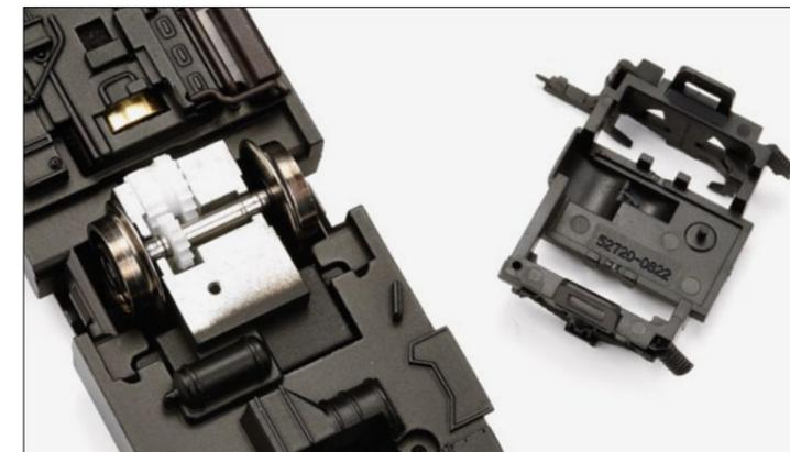
Über zwei gut abgestufte Getriebe erreicht der VT 98 ein seidenweiches und nahezu lautloses Fahrverhalten. Die Bodenplatte kann mühelos entfernt und wieder aufgesetzt werden. Fotos: MK
