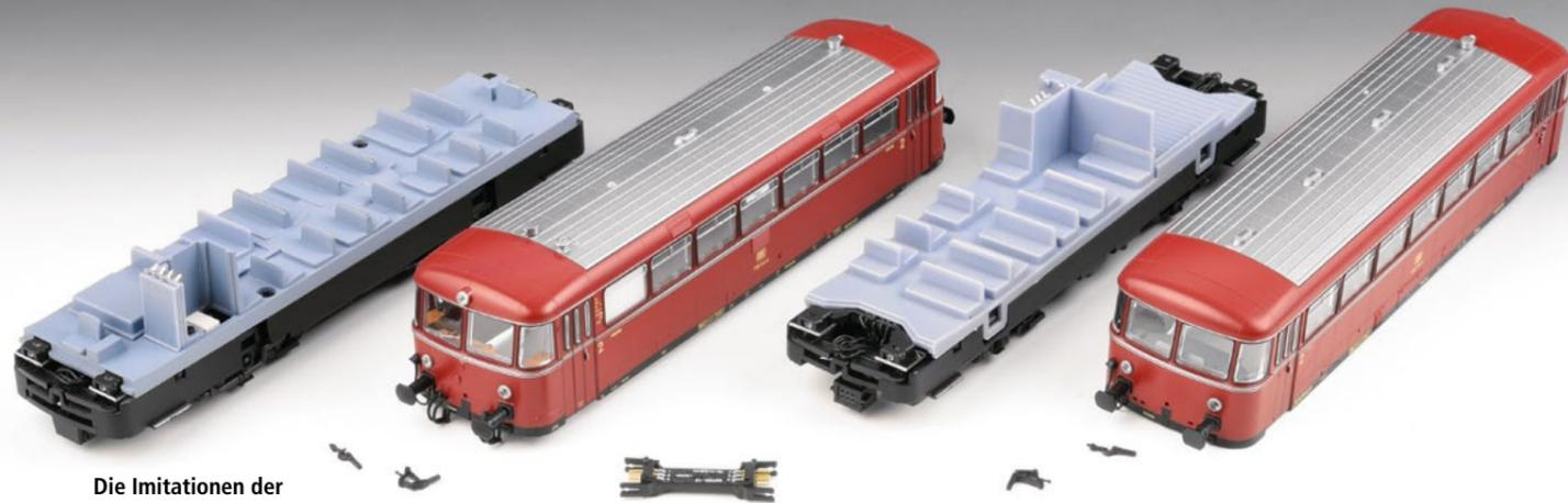
Die Imitationen der Schraubenkupplungen müssen abgezogen werden, dann können die Gehäuse abgehoben werden.
