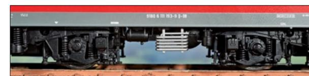
Die Drehgestelle sind nicht nur äußerst plastisch graviert, sie haben zudem auch separat angesetzte Sandkästen, Geberleitungen und Schneeräumer. Links: Farblich in Silber abgesetzt der Nachkühlers des Kompressors
