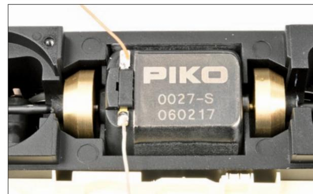
In der Lokmitte lagert ein Motor aus hauseigener Fertigung, der zwei Schwunghmassen trägt, die zugleich auch als Lagerschalen für die Kardanwellen dienen. In den Drehgestellen sind sämtliche Räder – davon zwei mit Haftreifen – über gut abgestufte Schnecken-Stirnradgetriebe angetrieben. Der komplette Antriebsstrang läuft dabei in sämtlichen Geschwindigkeitsbereichen nahezu lautlos. Fotos: MK
