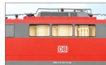
Sämtliche Lichteffekte des Vorbilds sind am Modell berücksichtigt. Über einen Jumper kann die Maschinenraumbeleuchtung dauerhaft eingeschaltet oder einer Funktionstaste zugewiesen werden. Besonders gut wirkt der Zugzielanzeiger, der allerdings nur bei einer Lok mit Decoder illuminiert werden kann. Links: Bei Tageslicht blickt man durch die Maschinenraumfenster auf eine Blende.
