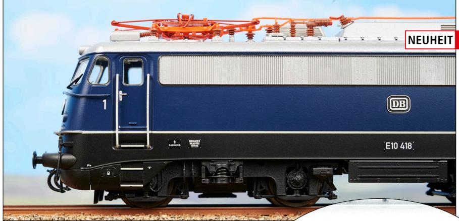
Die Silhouette der E 10.3 wirkt auch heute noch sehr dynamisch. Die Drehgestelle erreichen eine exzellente optische Tiefe und verfügen teils über extra angesetzte Leitungen. Bedruckung und Lackierung der neuen Piko-Konstruktion sind tadellos. Unter den erhabenen DB-Signets hätte sich ein ebenfalls angesetztes Lokschild sicher sehr gut gemacht.
